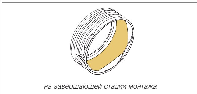
Рис. 2.6 Место контакта резинового уплотнителя и внутренней поверхности раструба
