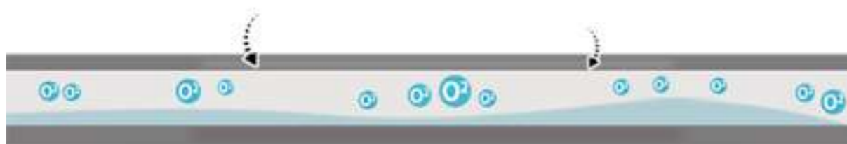
Коэффициент проницаемости кислорода обычных пластиковых труб более 0,5.
