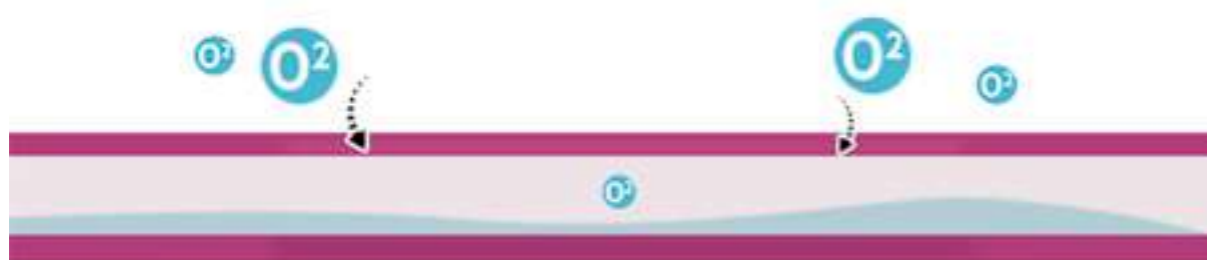
Коэффициент проницаемости кислорода труб One Plus PEX-a/EVOH составляет 0,1.
